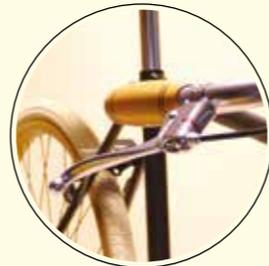
Permette il montaggio di un freno anteriore sui modelli #1910 e #1920, senza che sia intaccata la verniciatura del cerchio durante la frenata.
