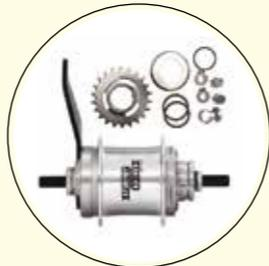
Permette di disporre di due rapporti di velocità senza comandi al manubrio. Per effettuare la cambiata basta un colpo di pedale indietro.
